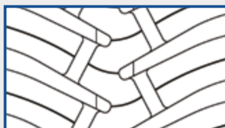
Gazeći sloj novog pneumatika Maksimalna dubina narezivanja 3 mm, širina narezivanja 9 mm.
