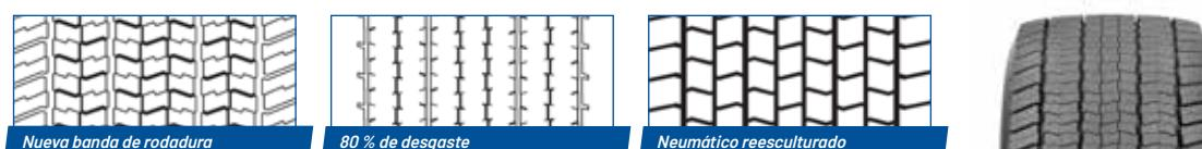
Profundidad máxima de reescalculado de 3 mm, ancho de reescalculado de 6-8 mm.
