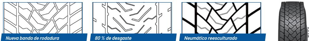
Máxima profundidad de reescalculado 3 mm, ancho de reescalculado 6 mm.
