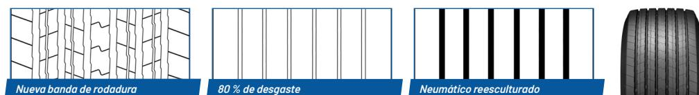
Profundidad máxima de reescalculado de 3 mm, ancho de reescalculado de 6-8 mm.
