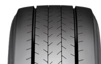
Máxima profundidad de reescalculado 3 mm, ancho de reescalculado 6-8 mm.
