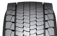
Máxima profundidad de reescalculado 3 mm, ancho de reescalculado 6 mm.
